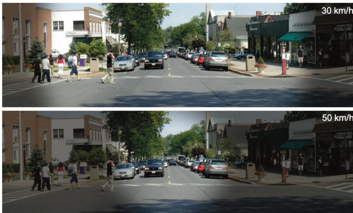
Fig. 13. Riduzione del cono visivo con la velocità. Fonte: NACTO 2013.
