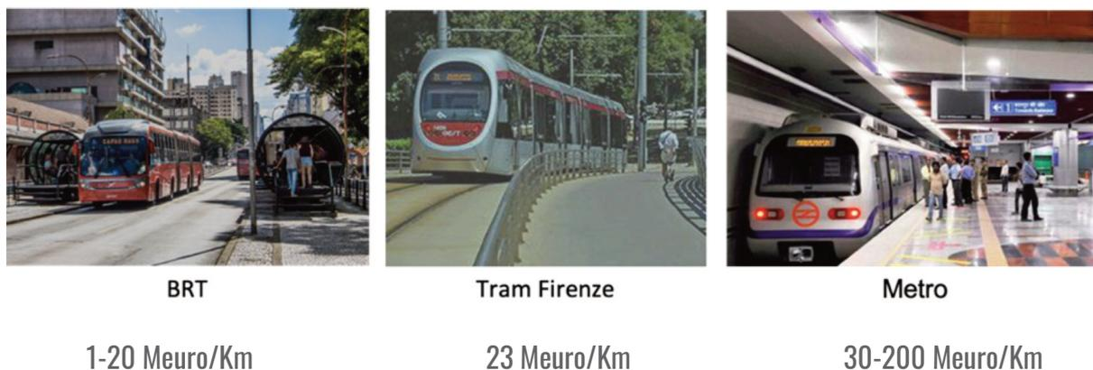
Fig 24. Confronto dei costi di costruzione e materiale rotabile per tre tipi di trasporto.
