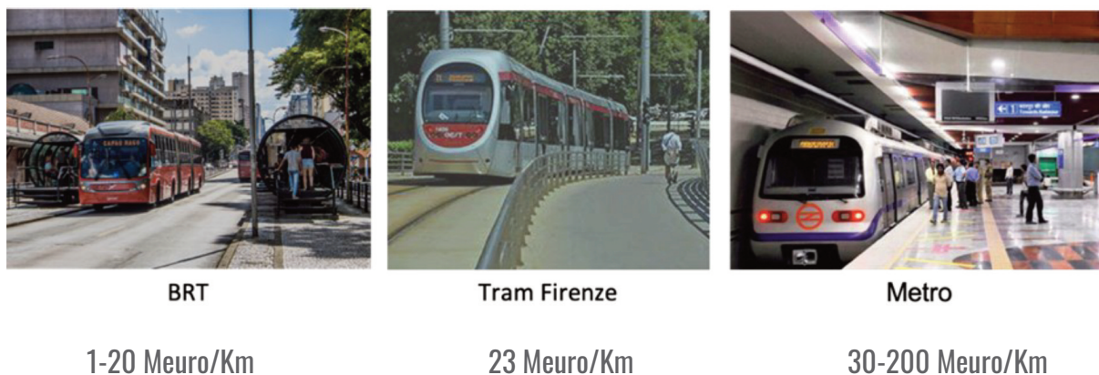
Fig 24. Confronto dei costi di costruzione e materiale rotabile per tre tipi di trasporto.
